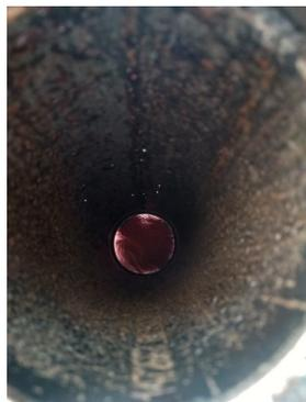
Ejemplo de elección incorrecta de material: picaduras en una chimenea en AISI 304 conectada a una estufa de pellets.
