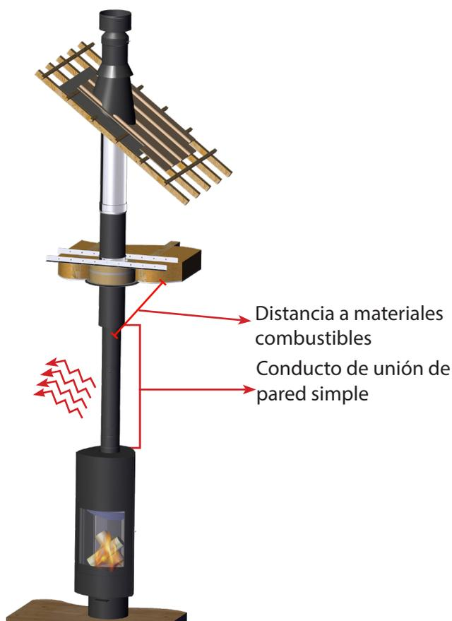
La distancia a los materiales combustibles de los conductos de unión metálicos de **pared simple** que estén conectados a chimeneas de salón, estufas e insertables de biomasa, debe ser, al menos, la equivalente a **tres veces su diámetro nominal, pero nunca inferior a 375 mm**. Esto quiere decir que antes de llegar a un forjado combustible, de madera por ejemplo, ya hemos de pasar a doble pared, de modo que se cumpla esta condición.
